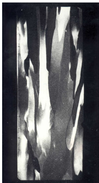
Рис. 1. Рентгеновские топограммы продольного (а) и поперечного (б) срезов профилированного кристалла LN.
