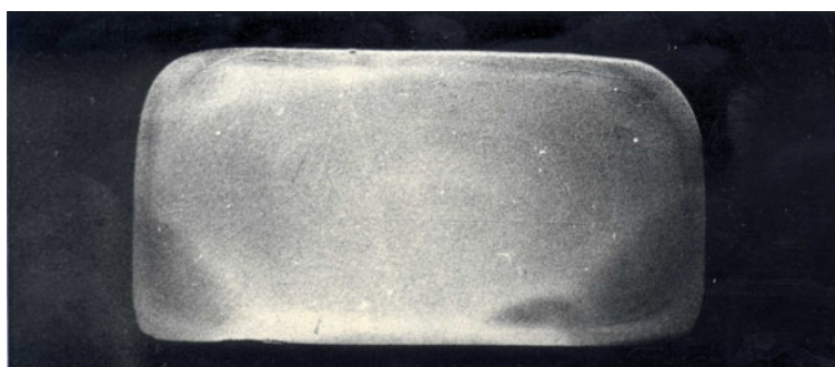
Рис. 2. Рентгеновская топограмма С-среза профилированного монокристалла SBN.
