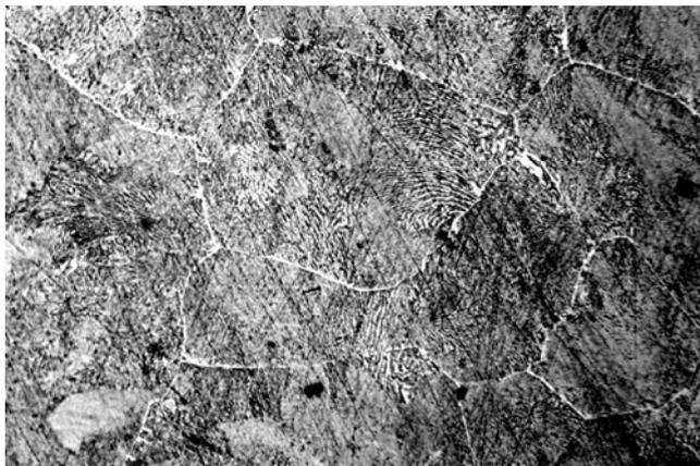
Рис. 7. Микроструктура заэвтектоидной стали
