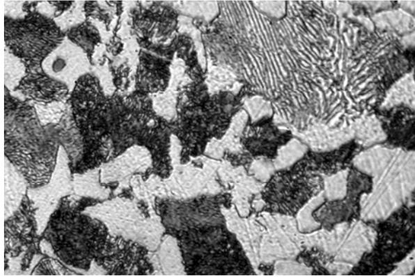
Рис. 5. Микроструктура доэвтектоидной стали
