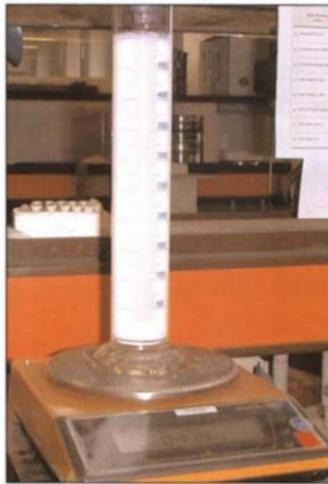
*Рис. 11 – Измерение плотности по весу и объему*
